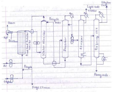
$$CH_2=CH_2 + 1/2 O_2 \rightarrow C_2H_4O + (CO_2 + H_2O)$$
